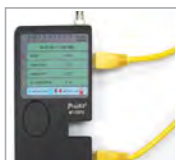
RJ45 Lan cable test
