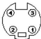
SVHS 4 Pin Mini Din Pinout
