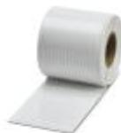
Kennzeichnungstreifen, Rolle, weiß, unbeschriftet, beschriftbar mit: THERMOMARK ROLL 2.0, THERMOMARK ROLL, THERMOMARK ROLL X1, THERMOMARK ROLLMASTER 300/600, THERMOMARK X1.2, Montageart: kleben, für Klemmenbreite: 3,8 mm, Schriftfeldgröße: endlos x 3,8 mm, Anzahl der Einzelschilder: 210000
